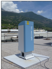
Lidar-ceilometer a depolarizzazione
